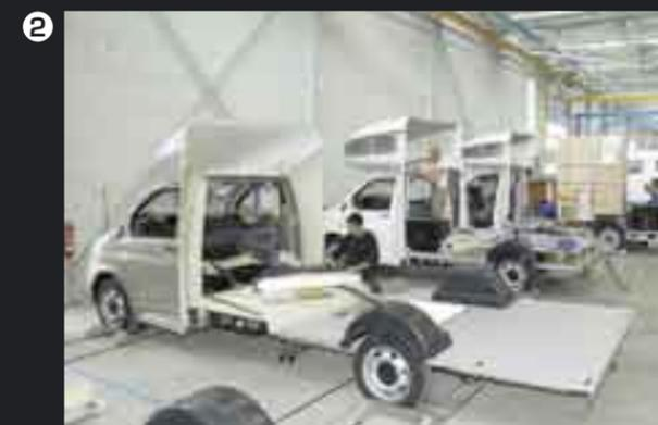
① La base de votre camping-car: le sol imputrescible est monté sur le châssis.
